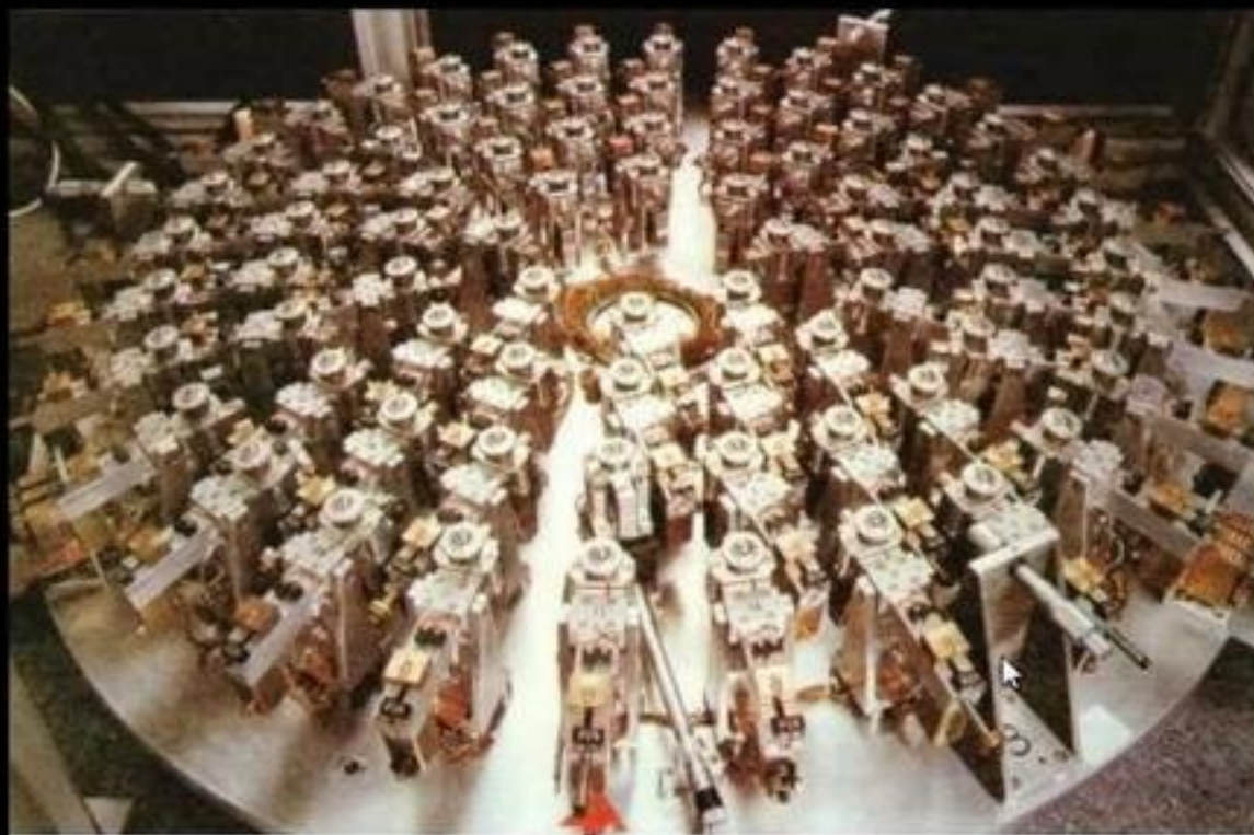
Figura 1 - Cella di uno specchio primario ad ottica attiva
